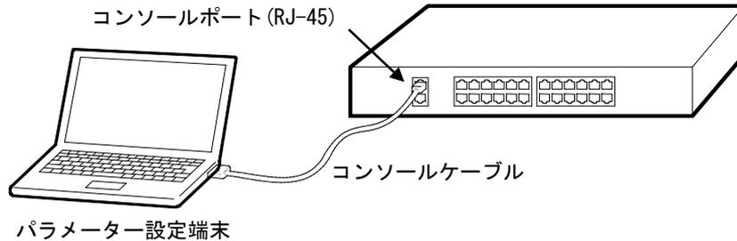
端末エミュレータの接続プロパティは以下のように設定してください。なお、エミュレーションモードを選択できる場合は、「VT100」に設定してください。
