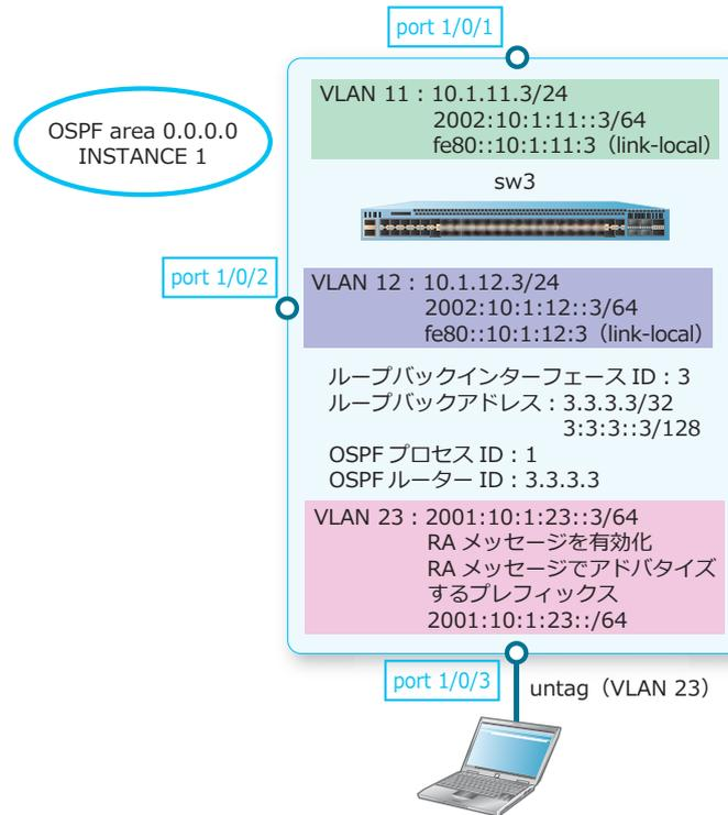
1. VLAN 11、VLAN 12、および VLAN 23 を作成します。
