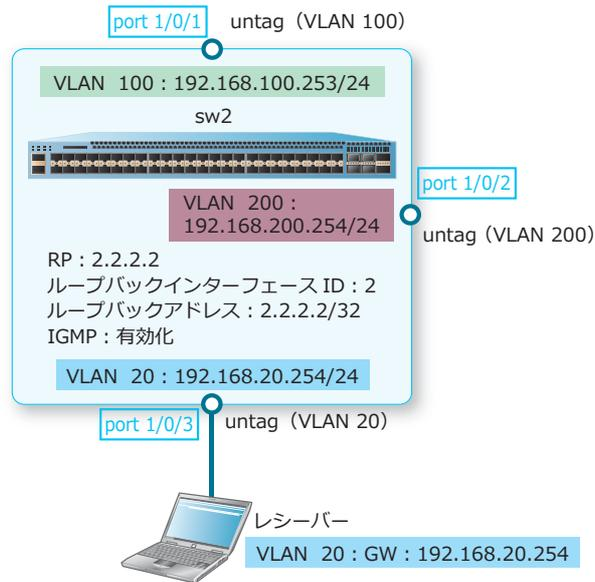
1. VLAN 20、VLAN 100、および VLAN 200 を作成します。
