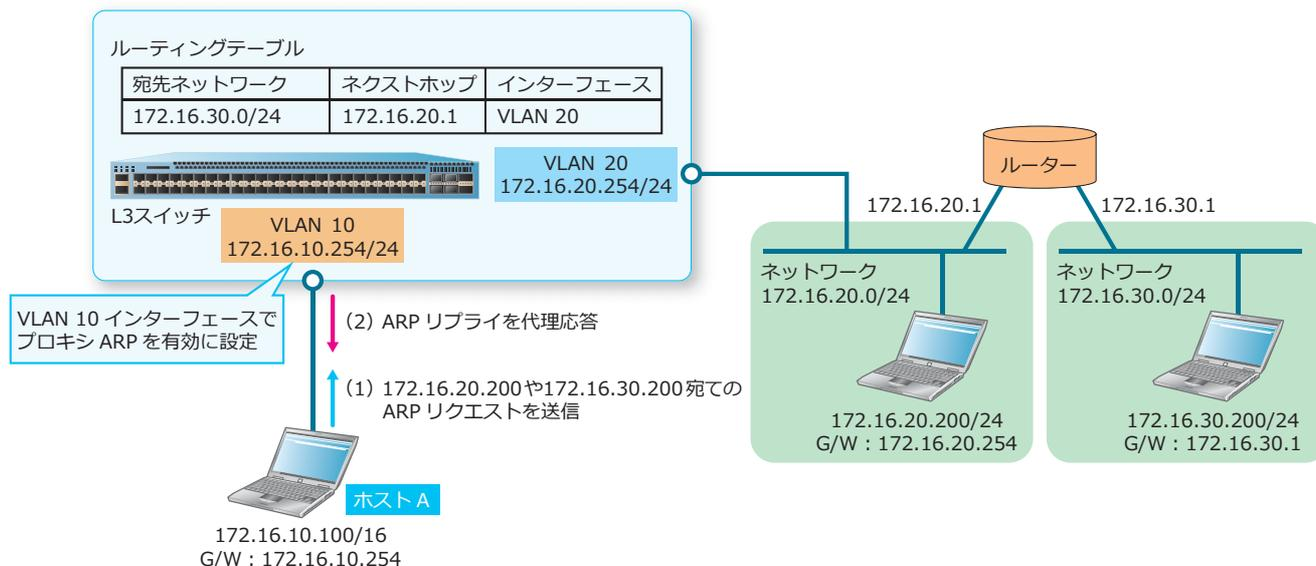
この例では、ホスト A の IP アドレス / サブネットマスクが 172.16.10.100/16 に設定されているため、ホスト A は 172.16.20.200 や 172.16.30.200 を同一サブネット内のホストと判断し、直接 172.16.20.200 や 172.16.30.200 宛てに ARP リクエストを送信します。L3 スイッチの VLAN 10 インターフェースではプロキシ ARP を有効にしているため、172.16.20.200（自装置に直接接続されているネットワーク）宛ての ARP リクエストや、172.16.30.200（ルーティングテーブルに経路情報が登録されているネットワーク）宛ての ARP リクエストを受信すると、VLAN 10 インターフェースの MAC アドレスを使用して ARP リプライを代理応答します。
