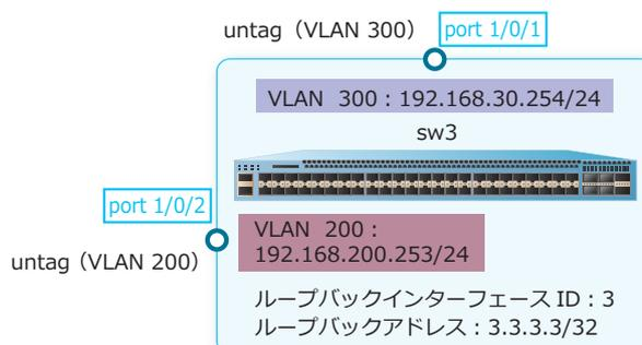
1. VLAN 200 および VLAN 300 を作成します。
