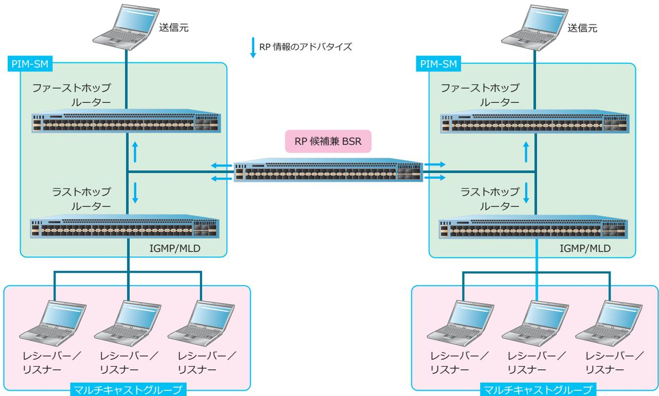
装置を BSR するには、IPv4 の場合は `ip pim bsr-candidate` コマンド、IPv6 の場合は `ipv6 pim bsr candidate bsr` コマンドを使用し、装置を BSR 候補に設定します。
