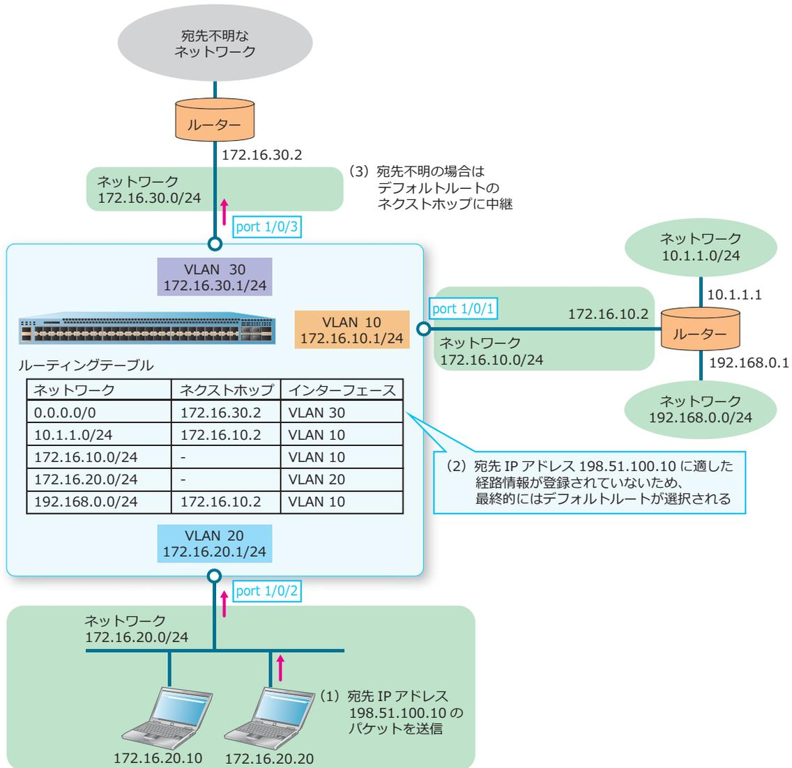
デフォルトルートは、ルーティングプロトコルによって学習するか、スタティックルートとして設定することで登録されます。IPv4 のデフォルトルートをスタティックルートとして設定する場合は、**ip route** コマンドで宛先ネットワークアドレスに 0.0.0.0/0 を指定して設定します。IPv6 のデフォルトルートをスタティックルートとして設定する場合は、**ipv6 route** コマンドで宛先ネットワークアドレスの代わりに default パラメーターを指定して設定します。
