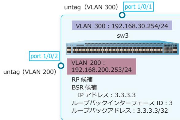
1. VLAN 200 および VLAN 300 を作成します。
