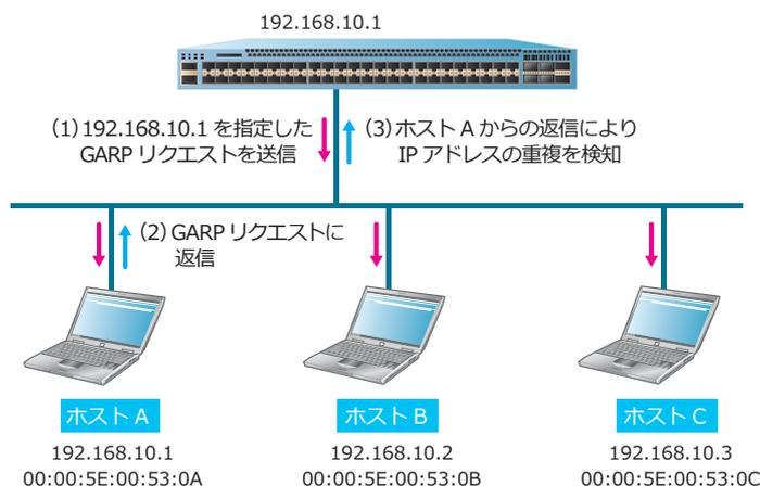
もう1つは、ネットワーク内のホストの ARP テーブルのキャッシュを更新する役割です。ネットワーク内のホストは、GARP リクエストを受信することで ARP テーブルのキャッシュを更新し、装置の IP アドレスと MAC アドレスの情報を最新の状態にアップデートします。
