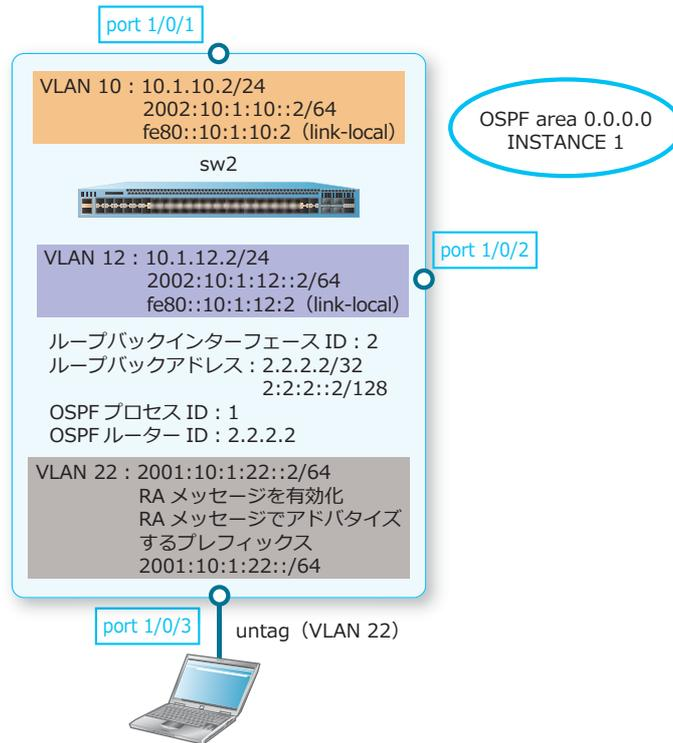
1. VLAN 10、VLAN 12、および VLAN 22 を作成します。
