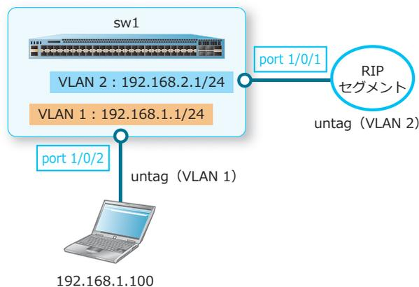
1. VLAN 1 および VLAN 2 を作成します。
