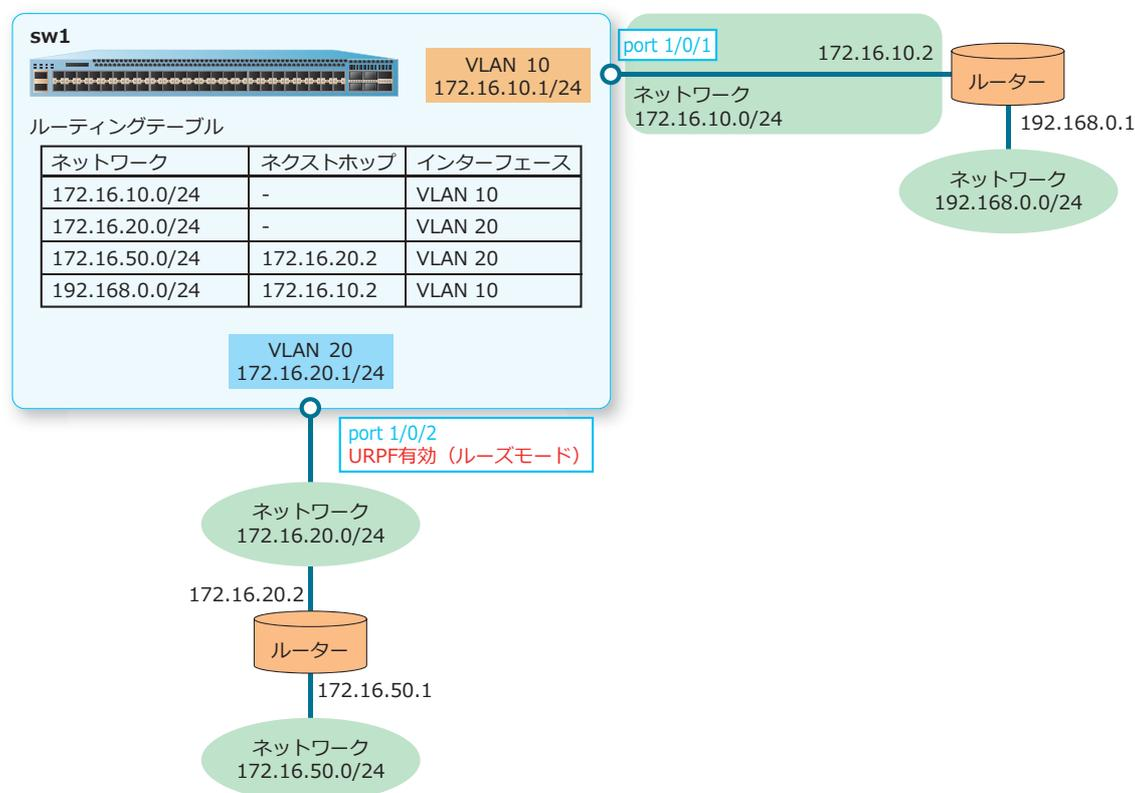
1. グローバル設定モードでユニキャストリバースパス転送 (URPF) を有効に設定します。設定を反映するためには、構成情報を保存して装置を再起動する必要があります。本設定例では、ip urpf を設定した時点で再起動し、反映しています。
