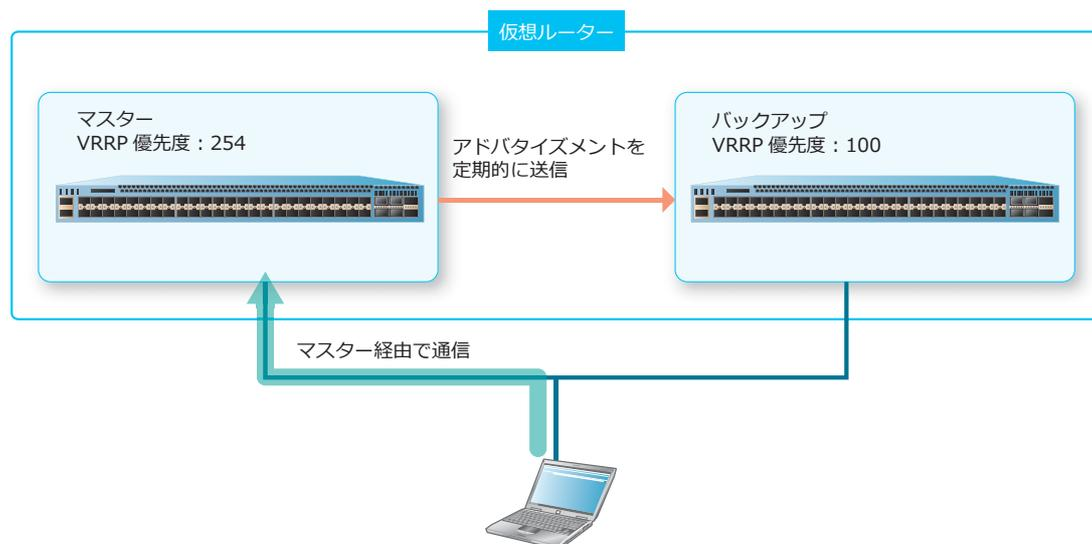
マスターに障害が発生してアドバタイズメントが送信されなくなり、設定した送信間隔が過ぎてもアドバタイズメントを検知できなくなった場合、バックアップがマスターに切り替わります。これによって通信処理がバックアップに引き継がれるため、通信停止時間を低減できます。
