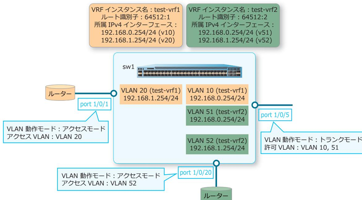
VRF インスタンス「test-vrf1」と「test-vrf2」の OSPFv2 設定と論理構成図を示します。VRF インスタンス「test-vrf2」では、OSPFv2 以外に IPv4 スタティックルートも設定しています。
