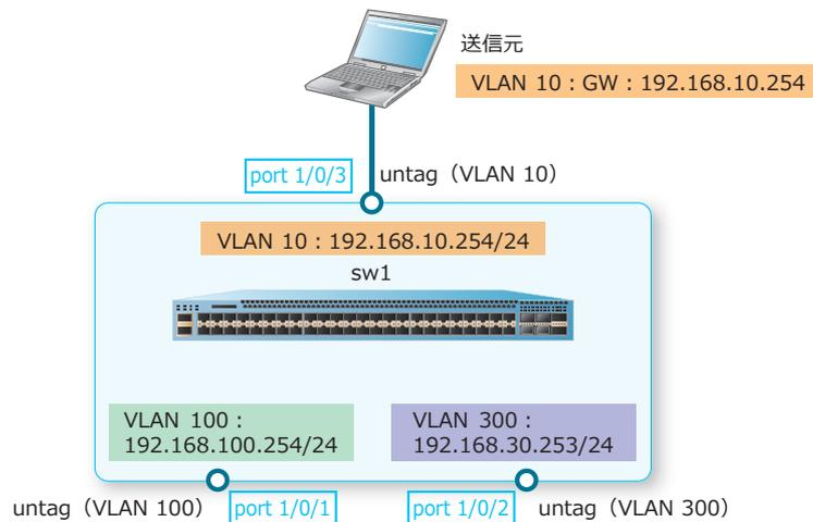
1. VLAN 10、VLAN 100、および VLAN 300 を作成します。
