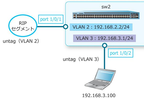
1. VLAN 2 および VLAN 3 を作成します。
