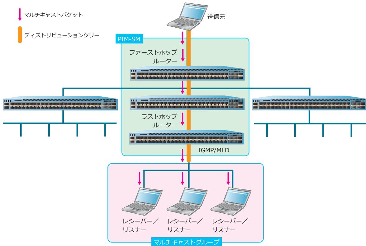
送信元からレシーバー/リスナーまでのディストリビューションツリーを**送信元ツリー**と呼びます。他の送信元が構成したディストリビューションツリーを共有するツリーを**共有ツリー**と呼びます。複数の送信元が存在する場合は、送信元ツリーと共有ツリーを組み合わせることでディストリビューションツリーを構成できます。
