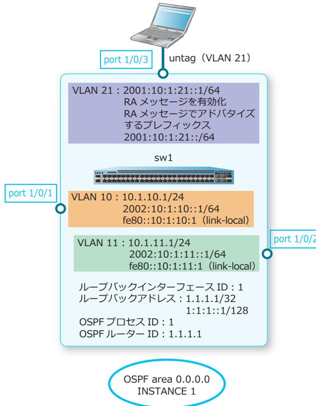
1. VLAN 10、VLAN 11、および VLAN 21 を作成します。
