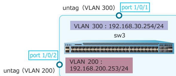
1. VLAN 200 および VLAN 300 を作成します。
