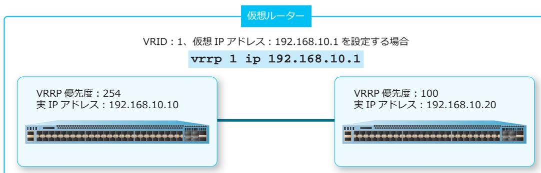
VRRPv3 の場合、`vrrp VRID address-family` コマンドで仮想ルーターの VRID を設定し、`address` コマンドで仮想ルーターの IP アドレスを設定します。
