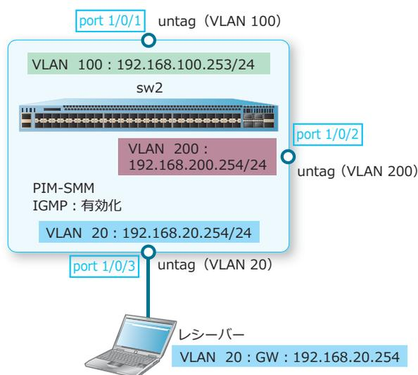
1. VLAN 20、VLAN 100、および VLAN 200 を作成します。
