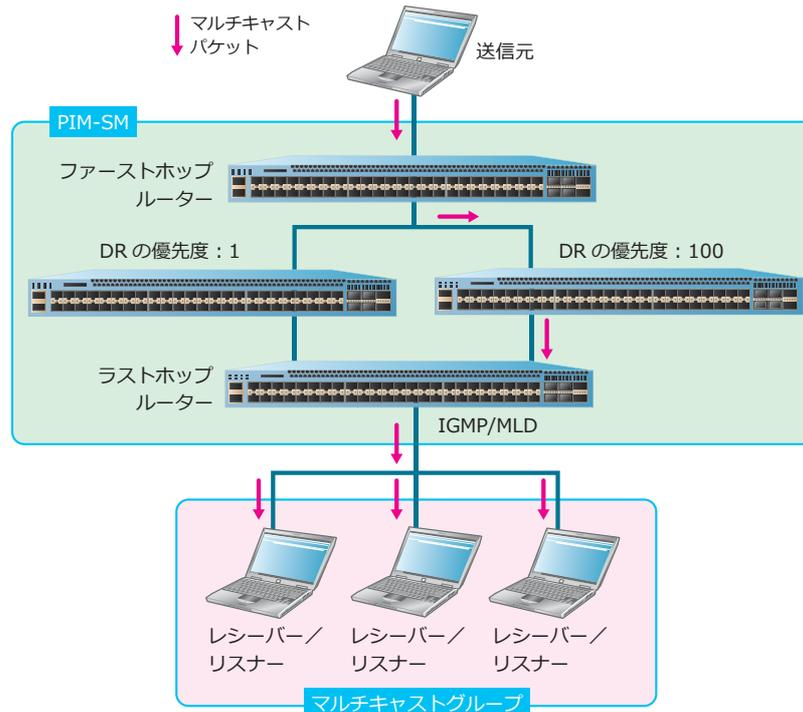
なお、PIM Hello メッセージで優先度をアドバタイズしていない装置が存在する場合、その装置に最も高い優先度が設定され、DR に選出されます。PIM Hello メッセージで優先度をアドバタイズしない装置が複数存在する場合、IPv4/IPv6 アドレスが最も大きな装置が DR になります。
