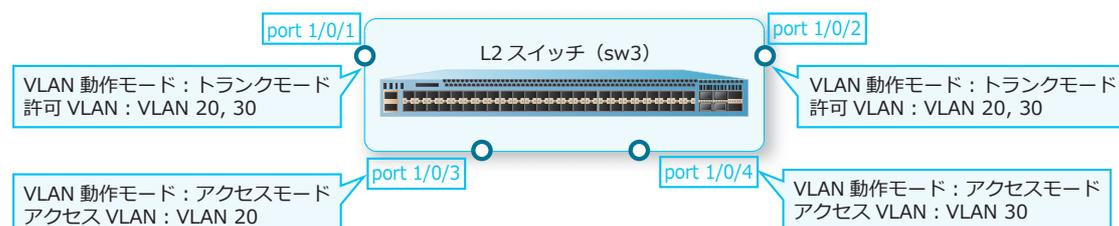
**1.** VLAN 20 および VLAN 30 を作成します。
