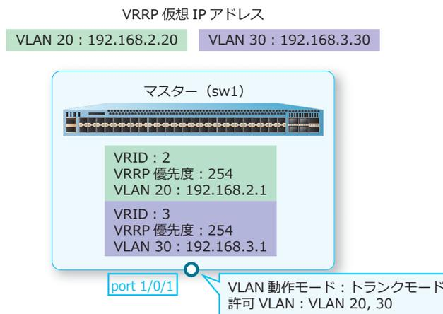
1. VLAN 20 および VLAN 30 を作成します。
