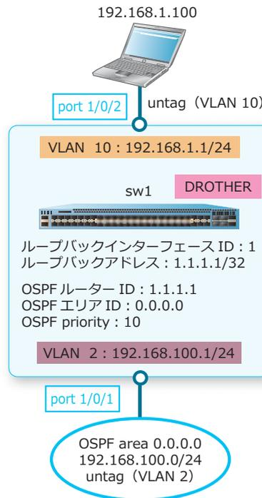
1. VLAN 2 および VLAN 10 を作成します。
