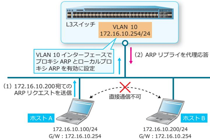
この例では、ホスト A (172.16.10.100/24) とホスト B (172.16.10.200/24) は同一セグメントに所属していますが、直接通信できない特殊なネットワークになっています。この環境でホスト A がホスト B (172.16.10.200) 宛での ARP リクエストを送信すると、L3 スイッチの VLAN 10 インターフェースではローカルプロキシ ARP を有効にしているため、自身のネットワーク (172.16.10.0/24) 宛での ARP リクエストを受信すると VLAN 10 インターフェースの MAC アドレスを使用して ARP リプライを代理応答します。これにより、同一サブネット内のホスト A とホスト B が L3 スイッチを経由して通信できるようになります。
