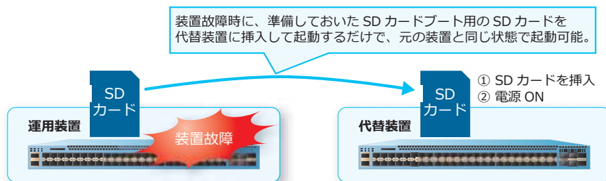
図 12-1 SD カードブートの概要
