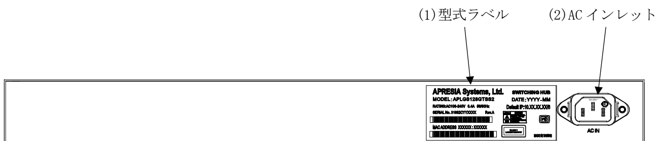
図 2-10 ApresiaLightGS128GT-SS/SS2 のリアパネルの構成
