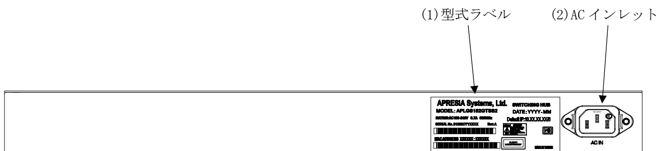
図 2-14 ApresiaLightGS152GT-SS/SS2 のリアパネルの構成
